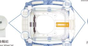
將前後輪組分別套入底盤下的輪軸孔內,並且 用力將輪軸壓到底。
